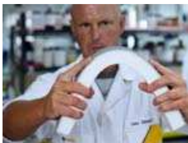
Der Biegeversuch zeigt die außerordentliche Elastizität und somit hohe Rissicherheit von StoTherm Classic.
